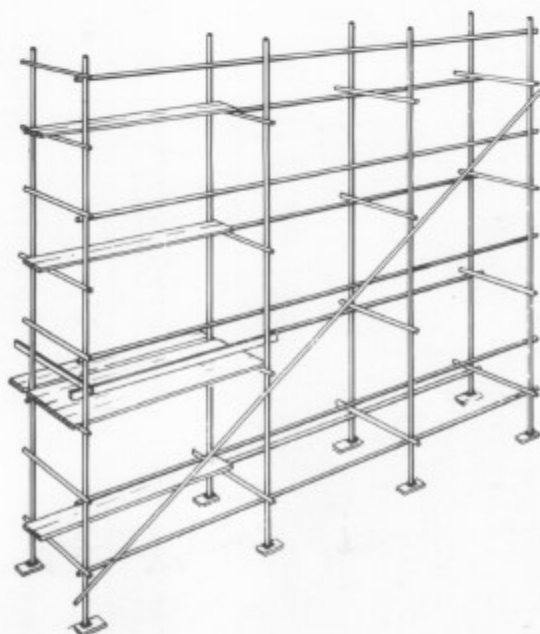
PUTSSTÄLLNING med bommar och liggare max 80 cm över marken och ett spiravstånd på 3,5 meter. Avståndet mellan bomlagen är 2 meter och endast ett bomlag är inplankat med 7 st. plank. Övriga bomlag har 2 plank vardera. Ställningsbredden är 110 cm.
